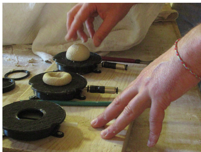
Essai du bullographe pour évaluer la force des pâtes
