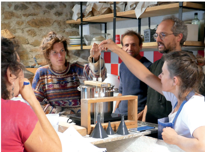
Mesure du «temps de prise de Mètis» sur des farines de seigle. Photo C. Firmat.
