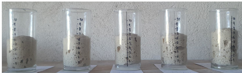
FIGURE 6 – Poussimètres avec de gauche à droite : Panis des Landes, Millet commun, Panis Jilin sans empois, Panis Jilin avec empois, Sorgho blanc.
